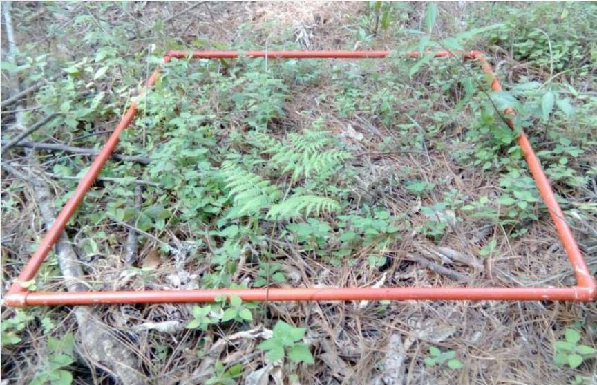
Para estimar el contenido de carbono en el estrato herbáceo, primero se calcula la cantidad de biomasa multiplicando el peso de la biomasa seca de la muestra (Mg) por el factor de expansión, normalmente 10000 (el muestreo se realizó en una superficie de 1 m<sup>2</sup>) para estimar los valores de la misma en Mg ha<sup>-1</sup>. Posteriormente el valor de densidad de biomasa se multiplicó por el factor recomendado por el IPCC (2003) de 0.5 para obtener la densidad de carbono en este estrato.
