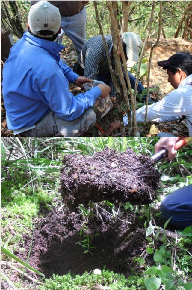
Con el dato de la biomasa seca y el porcentaje de carbono en la muestra (hojarasca y capa de fermentación), se calculó la cantidad de carbono en las muestras obtenidas de este reservorio y, posteriormente, se aplicó un factor de expansión por superficie de muestreo para obtener el valor en  $\text{Mg ha}^{-1}$ .
